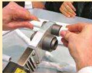
Hàn phụ kiện sử dụng khớp nối - Socket Fusion Welding Method
